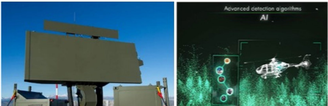
Representación de un radar de vigilancia GM-400 \alpha de la empresa Thales, que publica avances en su capacidad de detección utilizando algoritmos avanzados de IA. (Crédito: Thales 19 ).
